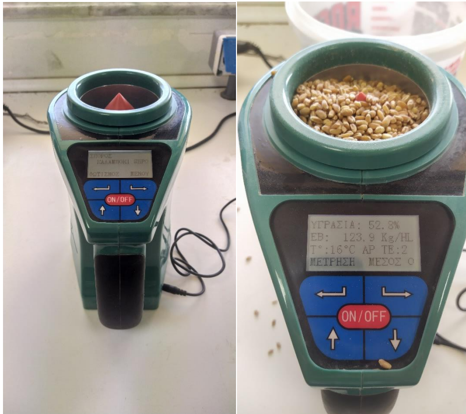
Εικόνα 1: Ειδικός μετρητής ειδικού βάρους δημητριακών και οσπρίων.
