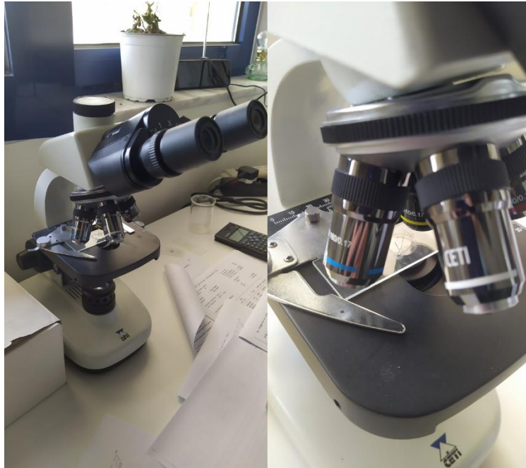
Εικόνα 15: Μικροσκόπιο για την αναγνώριση των μυκηλιακών υφών (Πηγή: Εργαστήριο Φυτοπαθολογίας)
